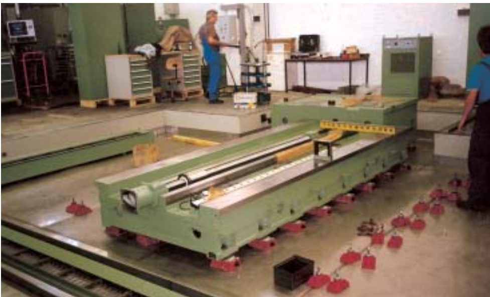
Fertiges BW-Fixatoren®-Feld mit aufgesetztem Maschinenbett.
